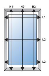
Tolérances de fabrication (hors toile)  $L: \pm 2 \text{ mm}, H: \pm 2 \text{ mm}.$
