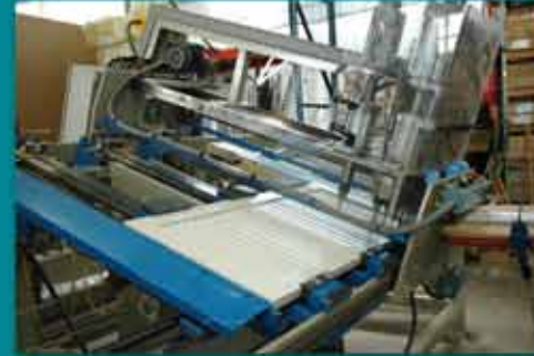
Le perçage automatisé du Ferrage
